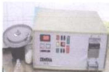
Appareil de test de dureté ERWEKA TBH
