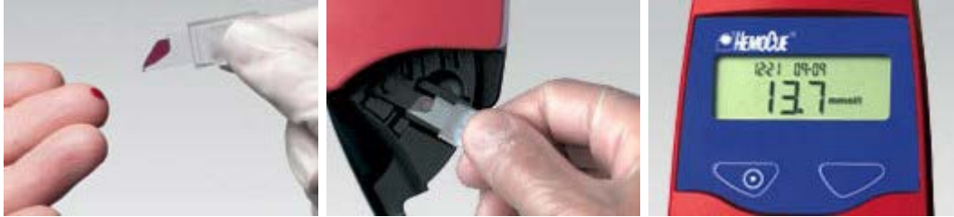
Figure 8 : Mécanisme de mesure du taux d'Hb par l'appareil HemoCue 201+
